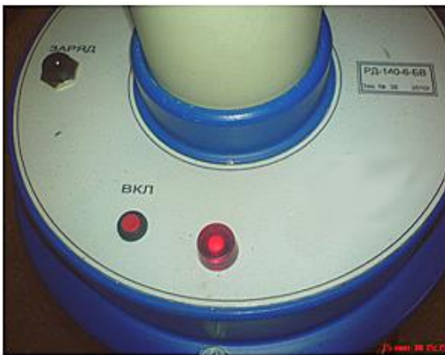
Рисунок 3. Расположение органов управления в МОЛНИЯ РД140-БВ
